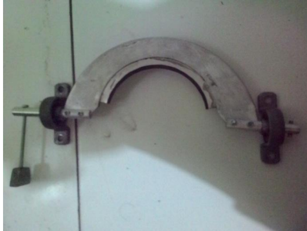
Gambar 3.5 Aktuator Wiper untuk Penghilang Embun dan Bekas Air Hujan Otomatis
