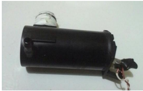
Gambar 4.11 Motor Pompa Mobil
