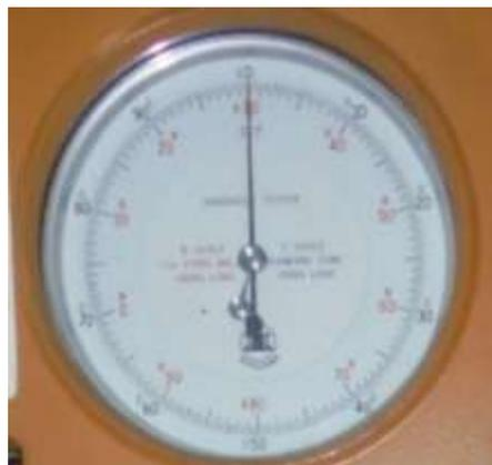
Gambar 3.13 Skala pembacaan uji kekerasan Rockwell
