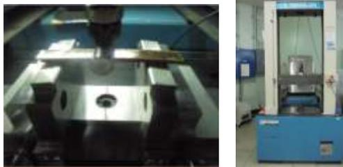
Gambar 3.11 Mesin Uji lengkung
