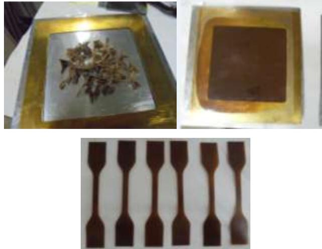
Gambar 3.7 Pembuatan spesimen uji tarik
