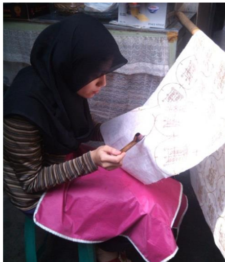
Gambar 3.57 Proses Pencantingan pada Karya 2 Sumber Gambar: Dokumentasi Pribadi
