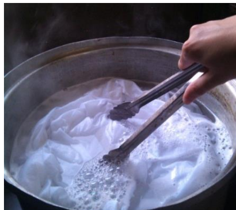
Gambar 3.52 Proses mengetel kain Sumber Gambar: Dokumentasi Pribadi
