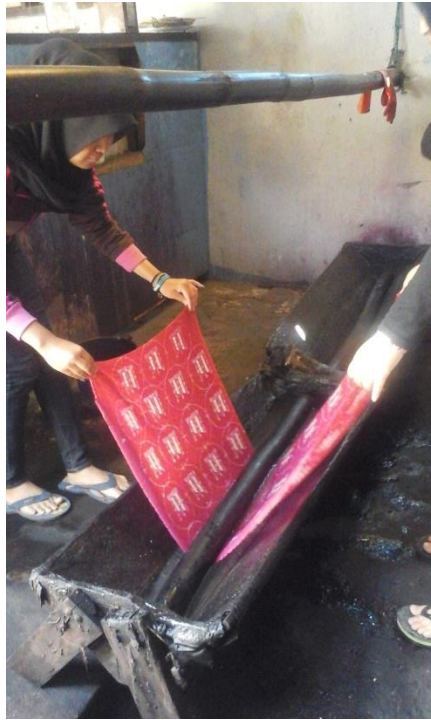
Gambar 3.63 Proses pencelupan karya ke-2 dengan warna magenta Sumber Gambar: Dokumentasi Pribadi
