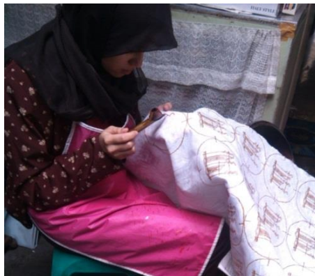
Gambar 3.58 Proses Pencantingan pada Karya 3 Sumber Gambar: Dokumentasi Pribadi
