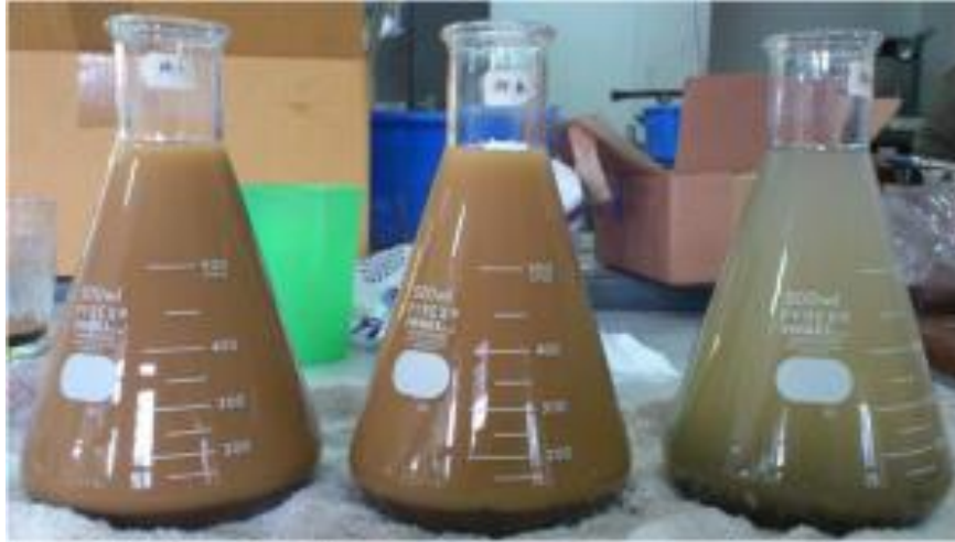
Gambar 3.10 Uji berat jenis dengan Erlenmeyer (Sumber : Foto di Laboratorium Mekanika Tanah DPTS UPI)
