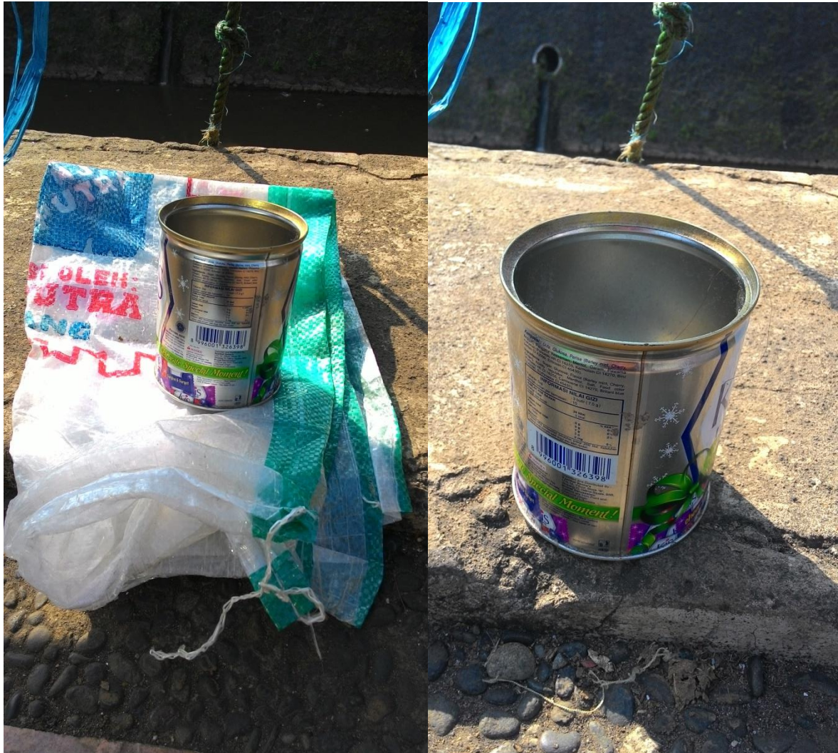
Gambar 3.3 Alat yang akan digunakan untuk pengambilan sampel sedimen (Sumber : Foto asli penulis di lokasi penelitian Sungai Cikapundung, Viaduct)
