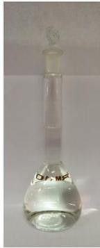
**Gambar 3.3** Larutan Uji  $\text{H}_2\text{SO}_4$  0,5 M
