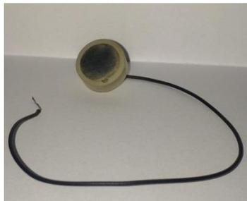
**Gambar 3.2** Baja Karbon (Elektroda Kerja)
