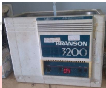
Gambar 3.10. Cleaning Ultrasonic produksi Branson tipe 3200
