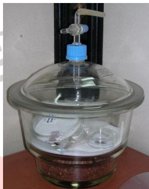
Gambar 3.26. Deccicator , tempat penyimpanan sampel dalam lingkungan nitrogen
