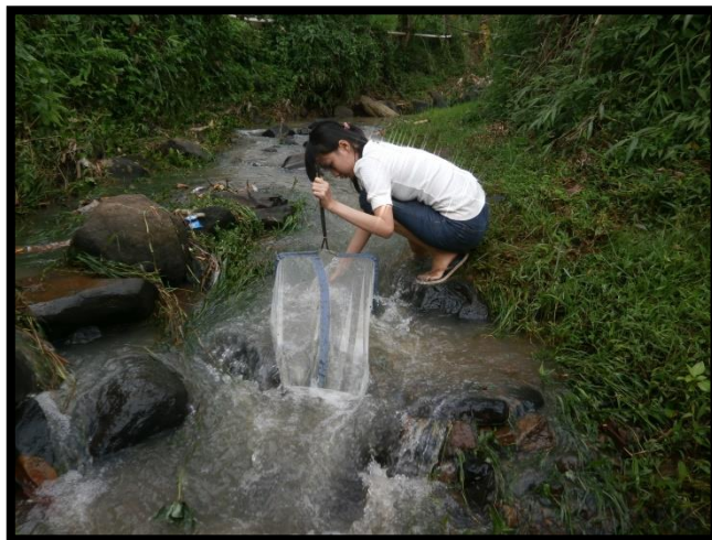
Gambar 3.6 Metode pencuplikan traveling kick-net Sumber : Dokumentasi Pribadi, 2015
