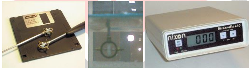
Gambar 3.4 Current Meter Mini Propeller model Nixon 430 Digital dan Perlengkapannya
