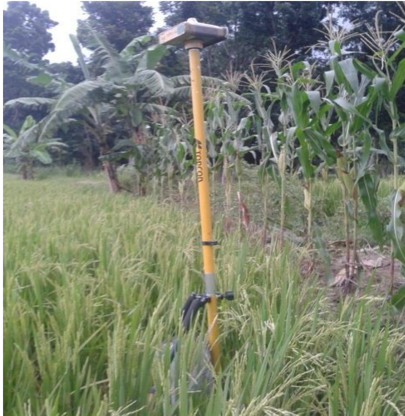
Gambar 3.3 Pengukuran GPS Geodetik Topcon Hiper GA 3 KPH Kendal
