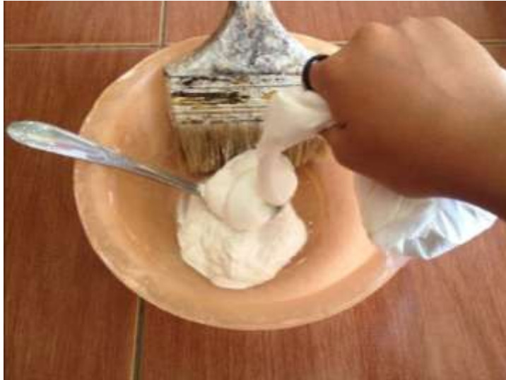
Gambar 3.27 Adonan cat tembok dan lem kayu (Sumber: Dokumentasi Penulis)
