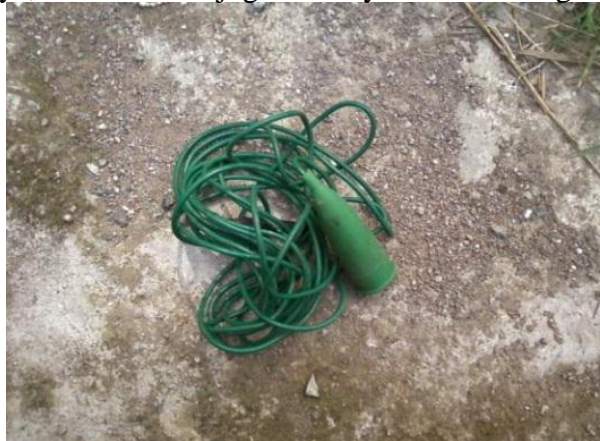
Gambar 3.5 Kabel penghubung elektroda batang
