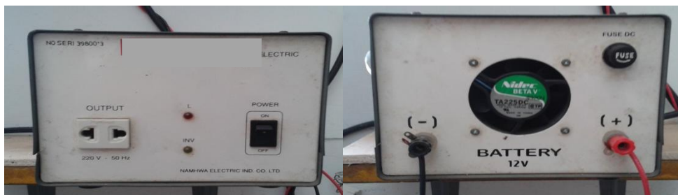
Gambar 3. 8 Inverter Sumber : Foto lapangan
