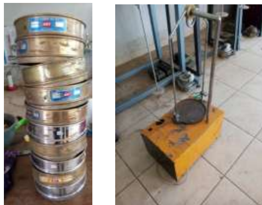
Gambar 3.3 Saringan dan sieve shaker untuk sieve analysis
