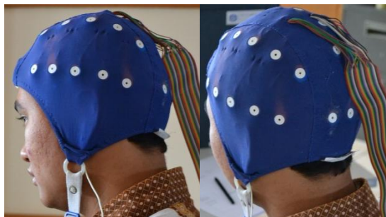
Gambar 3.6 Pemasangan ElectroCap pada subjek.
