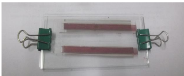
Gambar 3.20. Proses kapsulasi sel surya tampak atas
