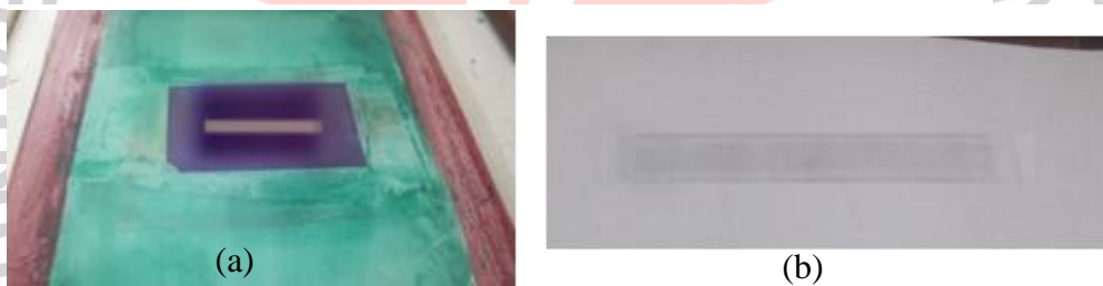
Gambar 3.13. Screen PEDOT:PSS (a) dan hasil printing PEDOT:PSS (b)
