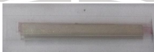
Gambar 3.18. Hasil evaporasi aluminium
