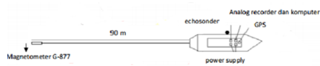
Gambar 4.5 Skema Sederhana Pengambilan Data Geomagnet
