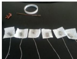
Gambar 3.2. Spesimen uji weight loss
