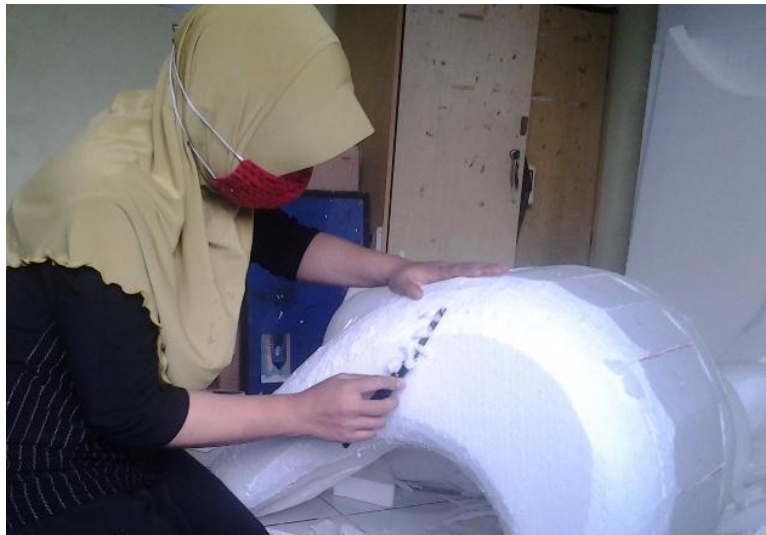
Gambar 3. 33 Penorehan styrofoam dengan menggunakan cutter (Sumber : Dokumentasi Penulis)
