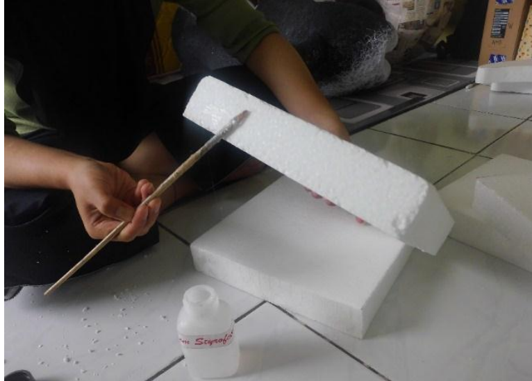
Gambar 3. 32 Menyatukan bagian-bagian styrofoam dengan menggunakan lem Styrofoam (Sumber : Dokumentasi penulis)
