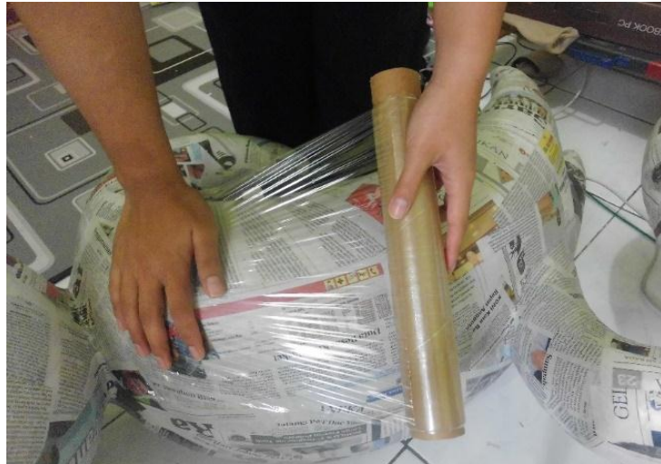
Gambar 3. 36 Membalut seluruh permukaan dengan menggunakan plastik wrap /plastik buah (Sumber : Dokumentasi penulis)
