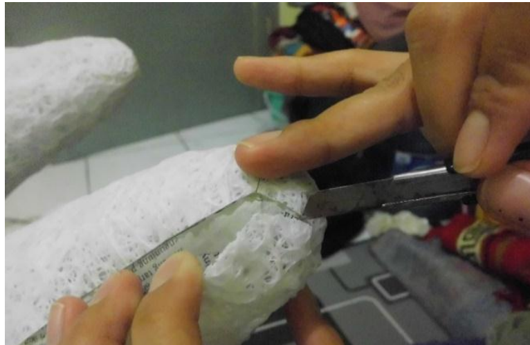
Gambar 3. 44 Pelepasan model dengan menggunakan cutter (Sumber : Dokumentasi penulis)
