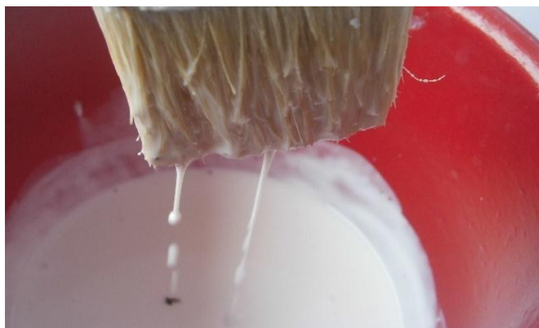
Gambar 3. 41 Lem kayu dengan kadar air banyak (Sumber : Dokumentasi penulis)
