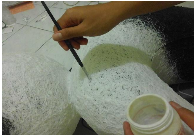
Gambar 3. 46 Pengeleman pada permukaan benang setelah dijahit (Sumber : Dokumentasi penulis)
