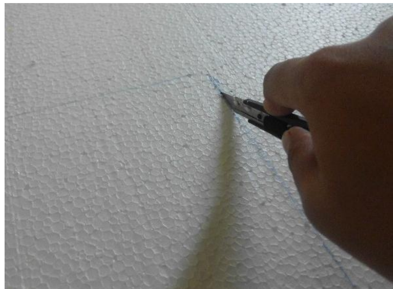
Gambar 3. 31 Memotong styrofoam dengan cutter (Sumber : Dokumentasi penulis)
