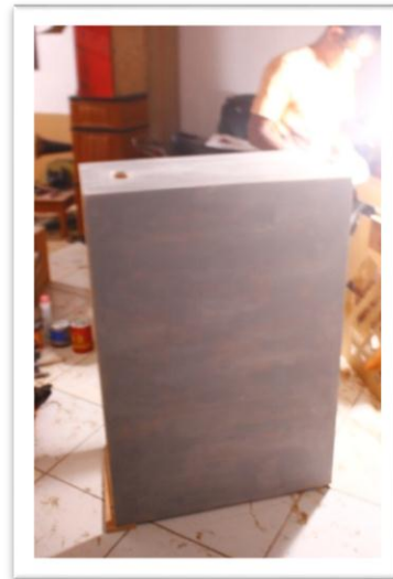
Gambar 3.97 Proses Melapisi Meja dengan Pyroxylin Lacquer Sumber : Dokumentasi Pribadi
