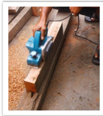
Gambar 3.56 Proses Penyerutan Kayu Sumber : Dokumentasi Pribadi
