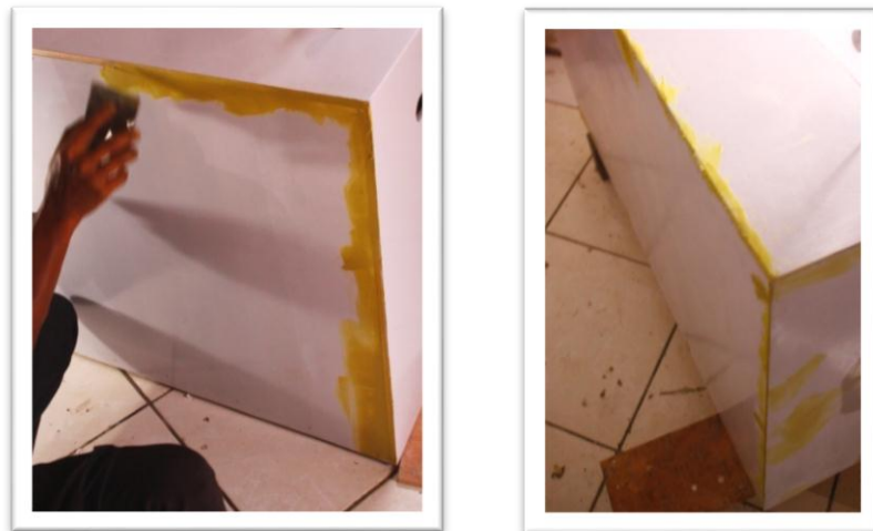
Gambar 3.99 Proses Mendempul Sumber : Dokumentasi Pribadi
