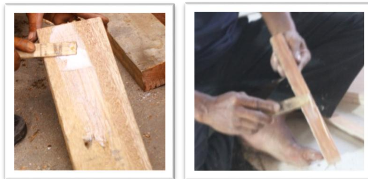
Gambar 3.60 Proses Pengeleman Kayu Sumber : Dokumentasi Pribadi
