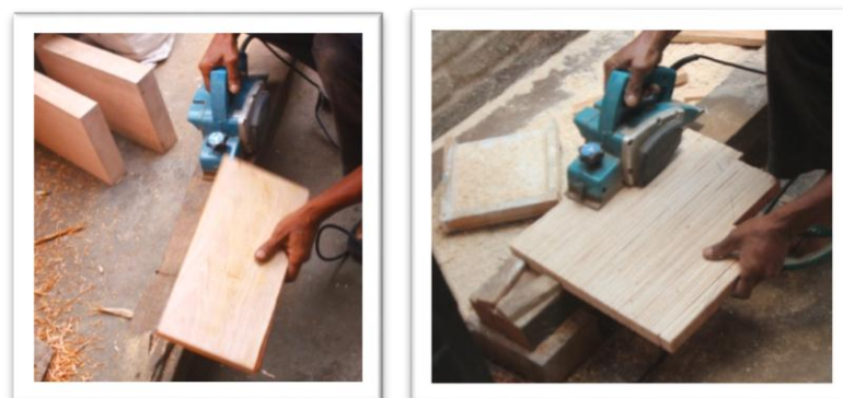
Gambar 3.68 Proses Penyerutan Kembali Sumber : Dokumentasi Pribadi
