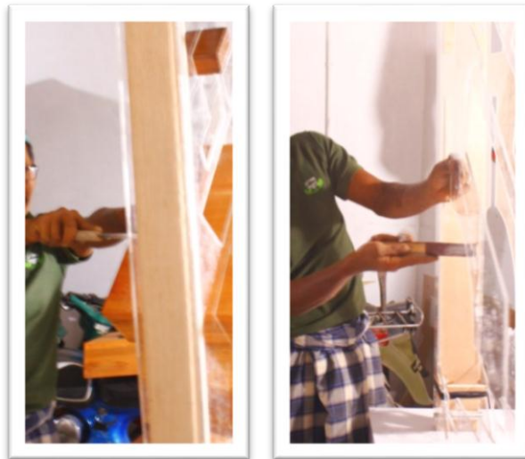
Gambar 3.87 Proses Pengikiran dan Pengamplasan Akrilik Sumber : Dokumentasi Pribadi
