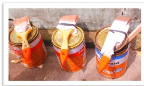
Gambar 3.76 Alat dan Bahan untuk Memelitur Sumber : Dokumentasi Pribadi
