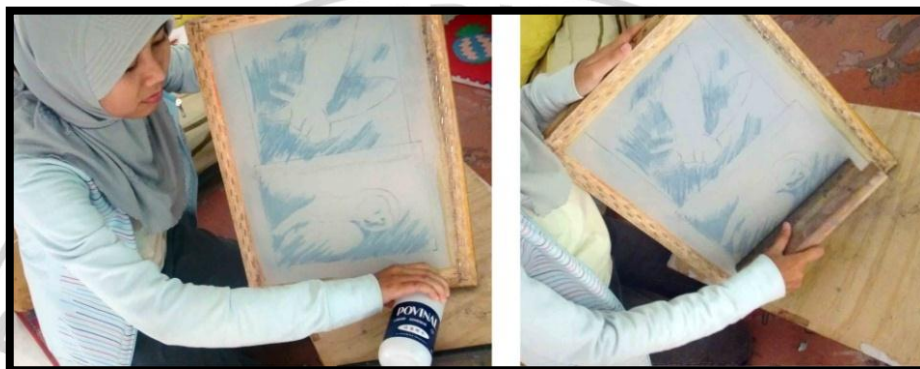
Gambar 3.17. Proses Penutupan dengan Lem Sumber : Dokumentasi Pribadi
