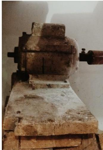
**Gambar 3.14 Gurinda (Mesin Pencetak Sol)**
