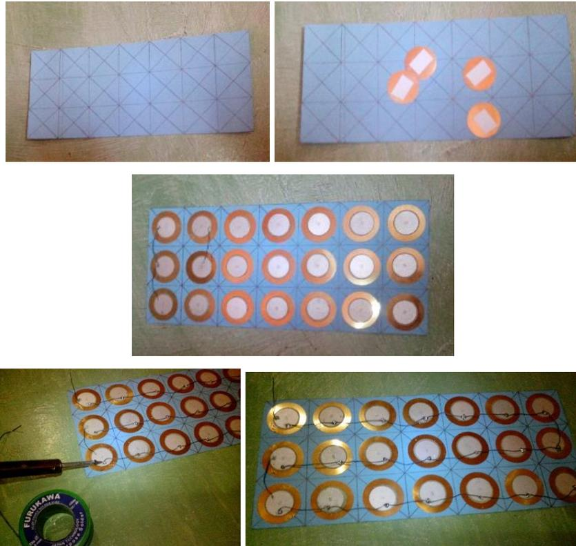
Gambar 3.4. Pemasangan Piezoelektrik Secara Paralel
