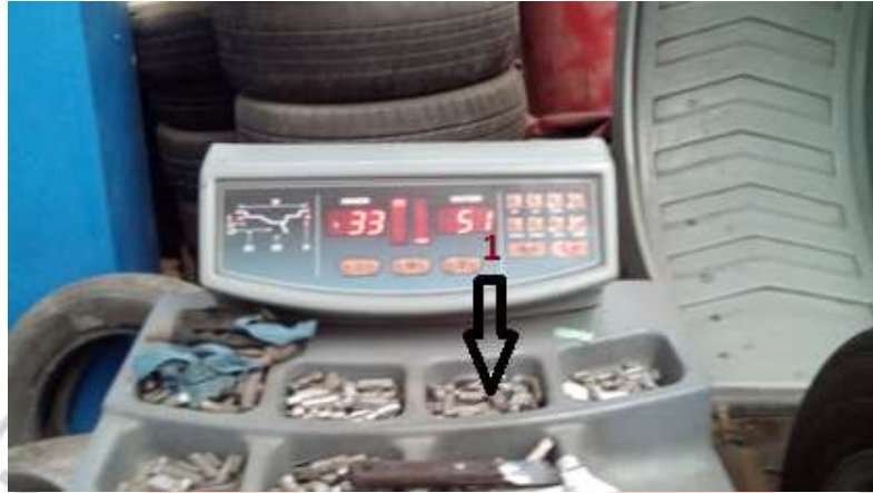
(Sumber: Dokumentasi Pribadi TA, 2013) Gambar 3.5 Timah Balancing
