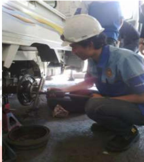
Gambar 3.6 SST Sliding Hammer (Sumber : Dokumentasi Pribadi 04/10/2013)
