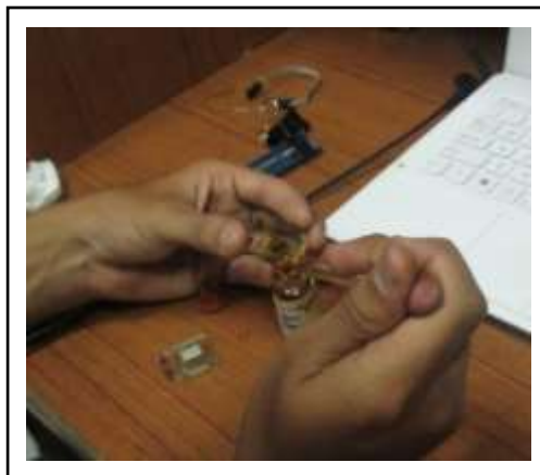
Gambar 3.7. Penambahan elektrolit pada sandwich DSSC
