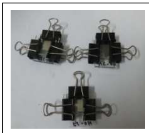
Gambar 3.6. Sandwich DSSC yang dibuat dengan dye Cordyline Fruticosa Aseton, dye Cordyline Fruticosa Etanol dan dye Cordyline Fruticosa Metanol
