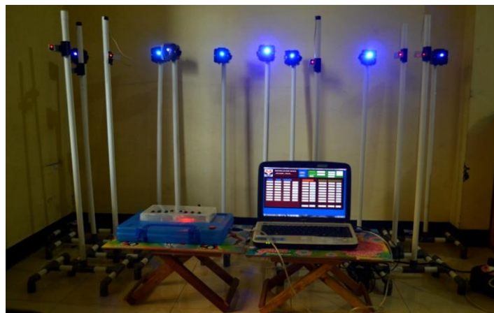
Gambar 3.3 Semua Komponen Alat ukur kecepatan lari berbasis mikrokontroler dengan interfacing personal computer (Redi Speed) (Sumber: Rahmat, 2014, hlm. 31)
