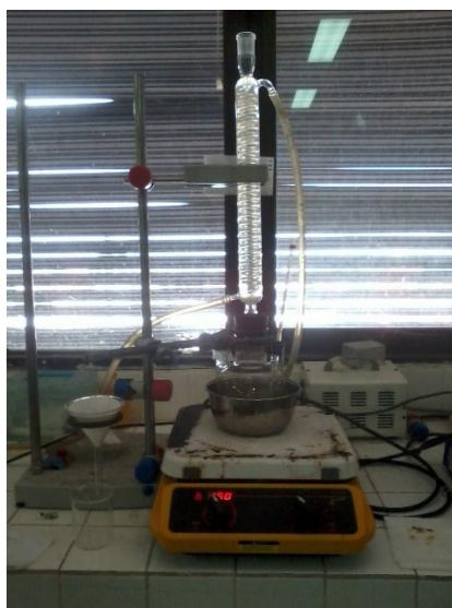
Gambar 3.2 Set Alat Hidrogenasi Minyak Permen.
