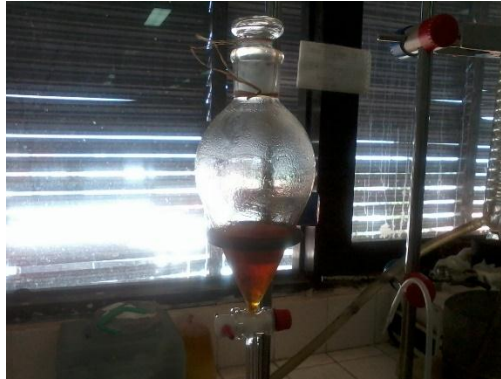
Gambar 3.4 Set alat ekstraksi
