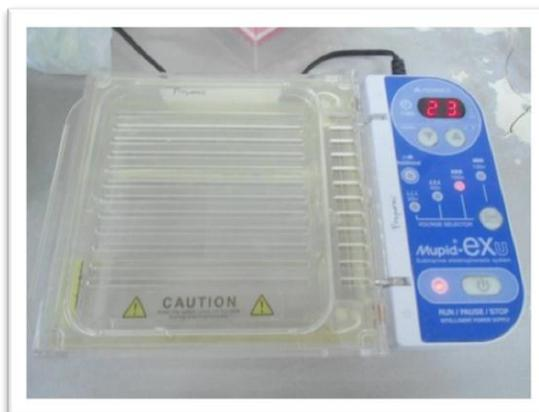
**Gambar 3.5. Alat untuk Elektroforesis**
