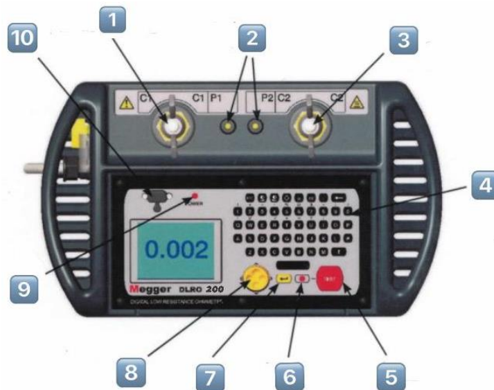
Gambar 3.4 Alat Uji Megger DLRO 200
