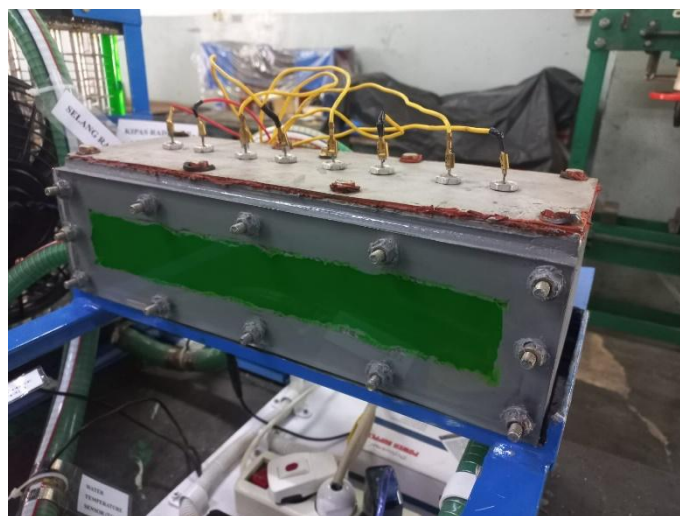
Gambar 4. 21 Pemasangan Kabel Pemanas
