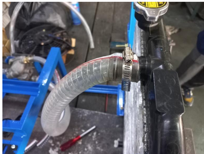
Gambar 4. 13 Pemasangan Selang Upper Tank
