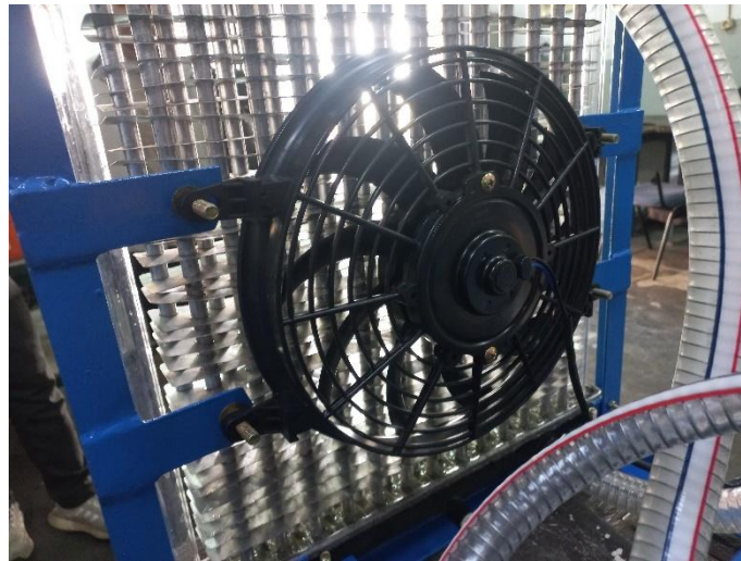
Gambar 4. 8 Pemasangan Kipas Radiator
