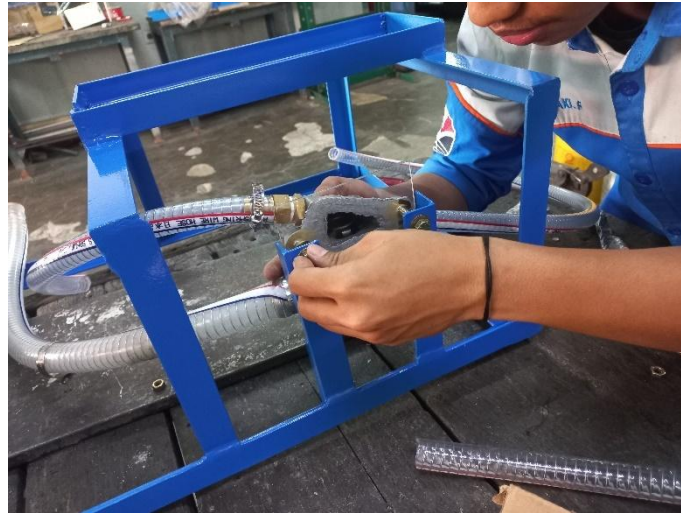
Gambar 4. 10 Pemasangan Baut Thermostat (Sumber: Dokumentasi Pribadi)
