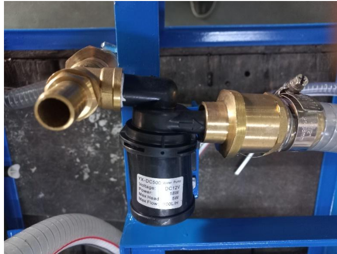
Gambar 4. 12 Pemasangan Pompa Air beserta Fitting Selangnya
