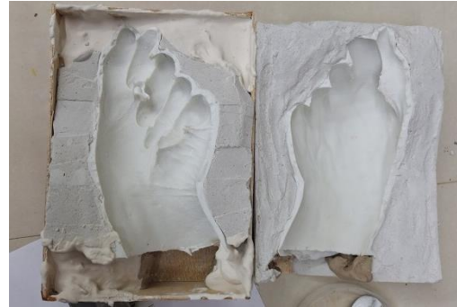
Gambar 3. 70 Pembuatan Cetakan Molding dengan Silicone Rubber RTV (Sumber: Dokumentasi Penulis, 2025).
