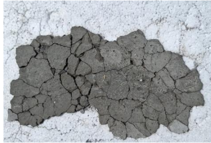
Gambar 3. 15 Acian semen yang dikeringkan di bawah terik matahari (Sumber: Koleksi Penulis, 2025).
