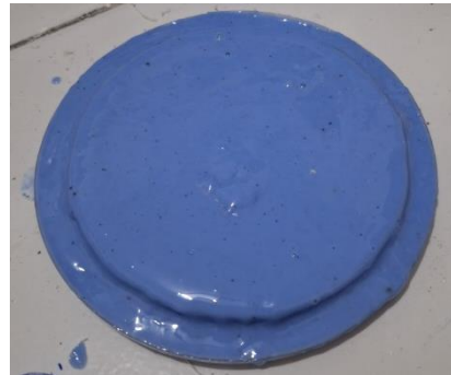
Gambar 3. 72 Pencetakan Koin dengan Resin (Sumber: Dokumentasi Penulis, 2025).
