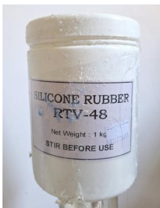
Gambar 3. 27 Material Cetak Silicone Rubber jenis RTV-48 (Sumber: Dokumentasi Penulis, 2025).
