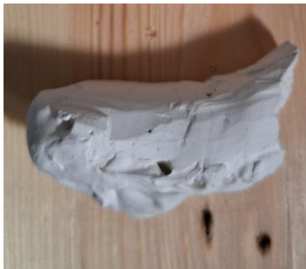
Gambar 3. 7 Gypsum jenis Cornice Adhesive setelah mengering (Sumber: Dokumentasi penulis, 2025).
