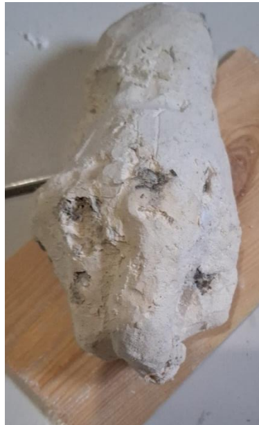
Gambar 3. 11 Hasil Studi Material Gypsum jenis Cornice Adhesive ketika pengeringan pada cetakan yang lembab (Sumber: Dokumentasi Penulis, 2025).
