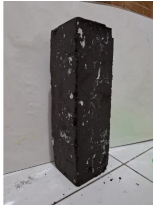
Gambar 3. 22 Studi teknik Cor Semen dengan Agregat Pasir (Sumber: Dokumentasi Penulis, 2025).
