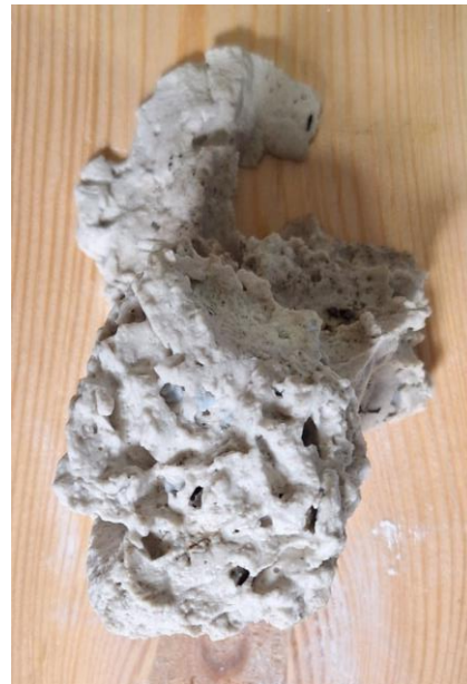
Gambar 3. 12 Hasil Studi Material Gypsum jenis Casting Plaster ketika disimpan di tempat yang banyak air, tetap mengeras (Sumber: Dokumentasi Penulis 2025).
