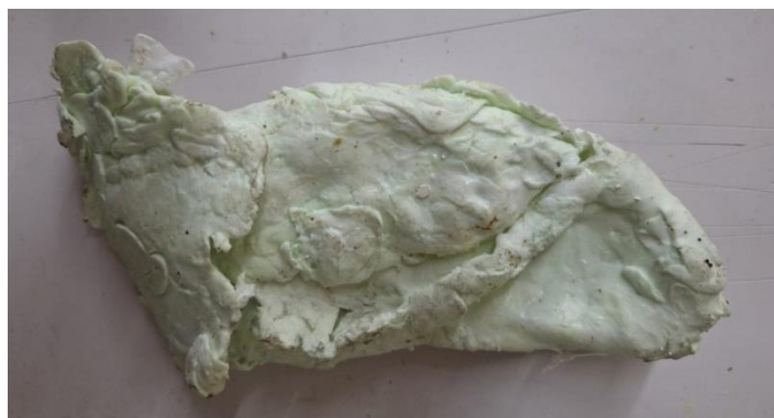
Gambar 3. 30 Cetakan yang dibuat dengan Lem Sealant (Sumber: Dokumentasi Penulis, 2025).
