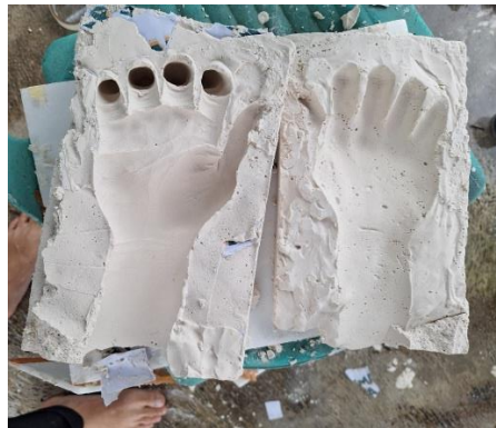
Gambar 3. 21 cetakan dengan gypsum (Sumber: dokumentasi penulis, 2025).
