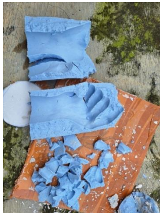
Gambar 3. 25 Cetakan Alginate biasanya hanya sekali pakai (Sumber: Dokumentasi Penulis, 2025).
