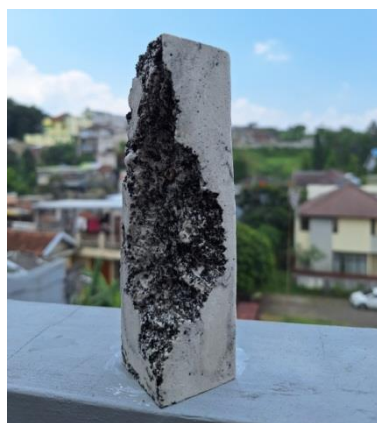
Gambar 3. 23 Studi Teknik Cor dengan Gypsum (Sumber: Dokumentasi Penulis, 2025).
