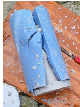
Gambar 3. 26 Proses Cetak cor dengan cetakan alginate (Sumber: Dokumentasi Penulis, 2025).
