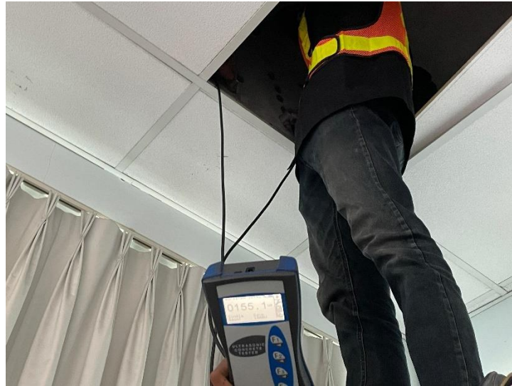
Gambar 3. 7 Contoh Pengujian Alat Ultrasonic Pulse Velocity
