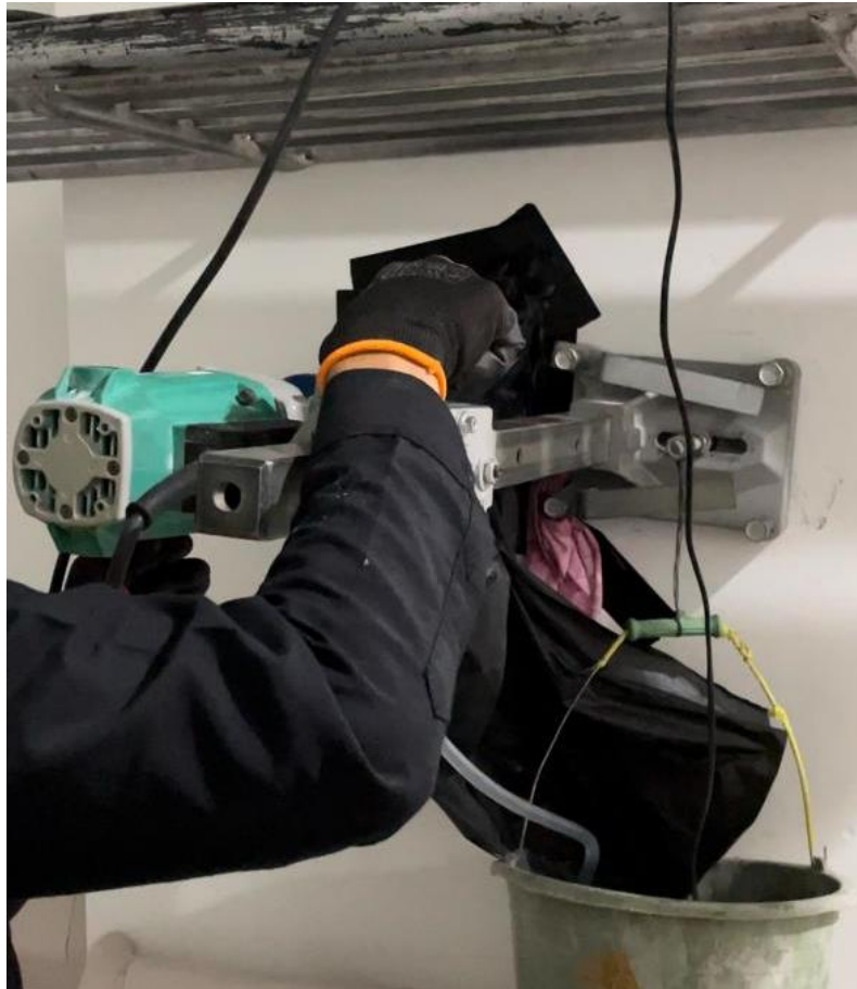
Gambar 3. 9 Contoh Pengujian Core Drill
