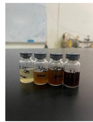
Hasil Pelindian Variasi Rasio Solid to Liquid Setelah Diencerkan
