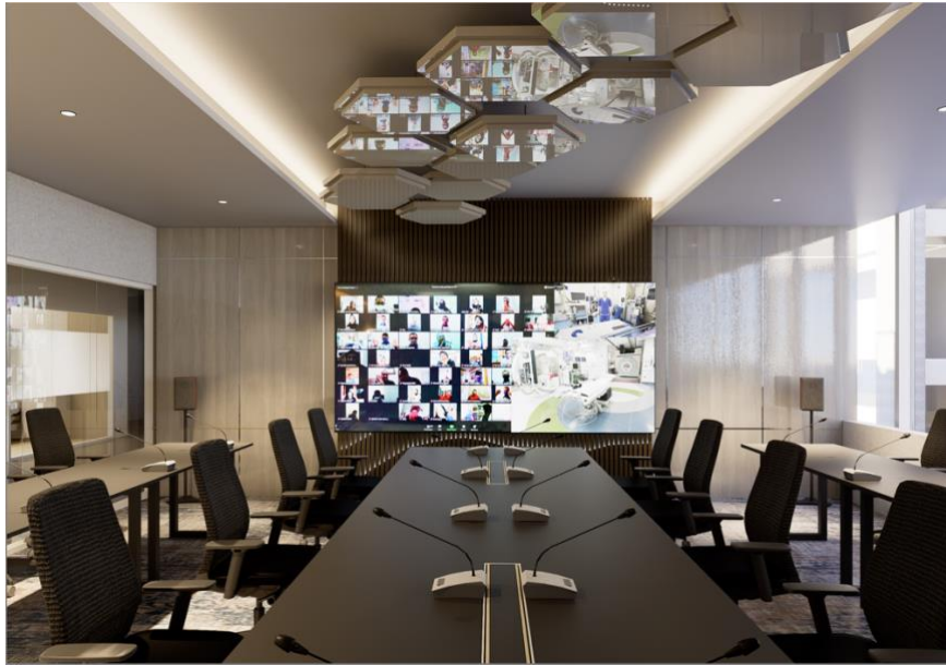
Gambar 29. Penggunaan Plafon dan Panel Dinding Akustik untuk Mencapai Kualitas Akustik Ruang Optimal
