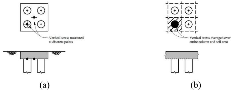
Gambar 3. 3 Penentuan Perhitungan Tegangan pada Tanah dan Kolom (a) Metode pengambilan titik (b) Metode area Sumber: Killeen (2012)
