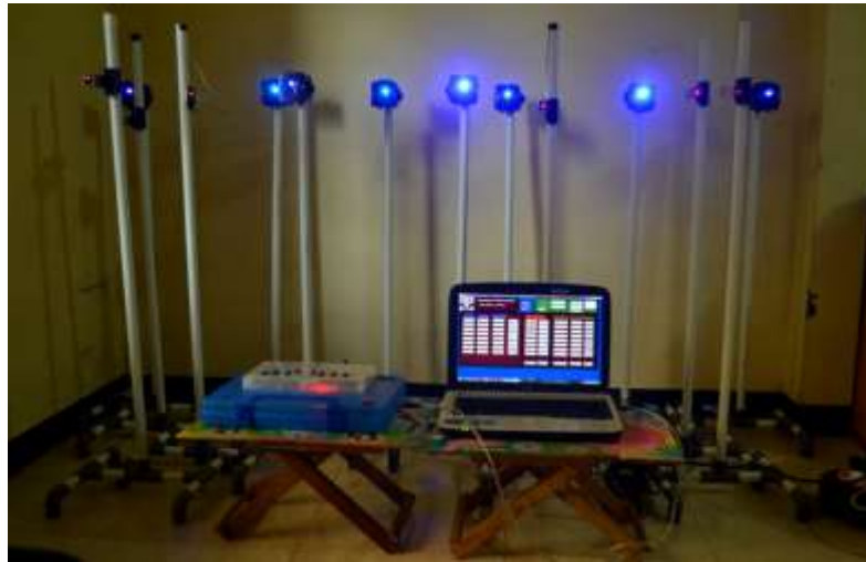
Gambar 3.2 Semua Komponen Alat ukur kecepatan lari berbasis mikrokontroler dengan interfacing personal computer (Redi Speed)
