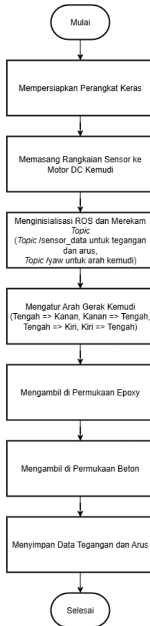
Gambar 3. 4 Flowchart pengumpulan data dengan sensor dari motor DC kemudi
