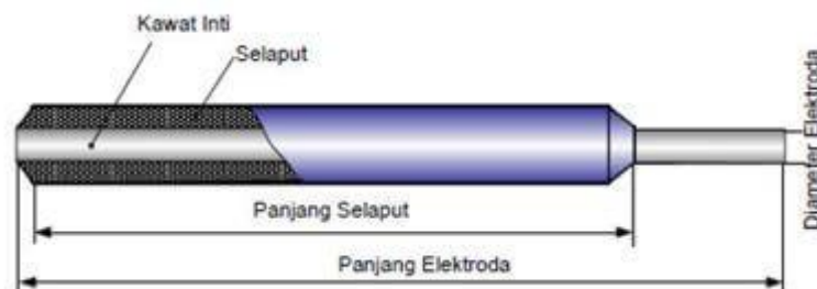
Gambar 4. 15 Bagian-bagian Elektroda SMAW
