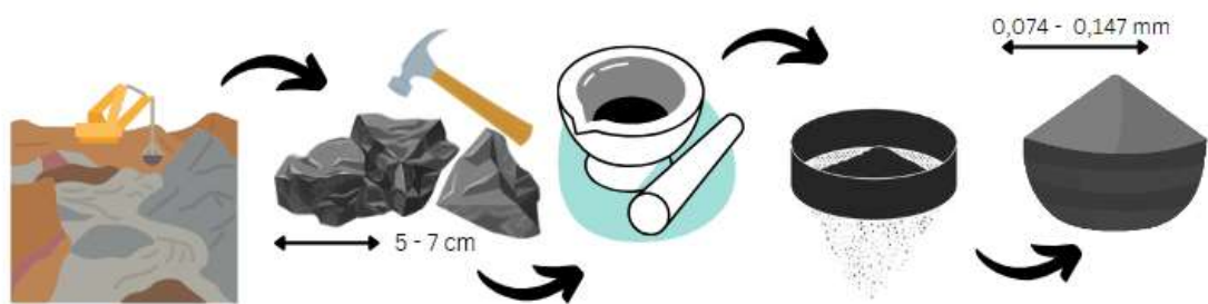
Gambar 3.2: Visualisasi Preparasi Sampel Bijih Mangan
