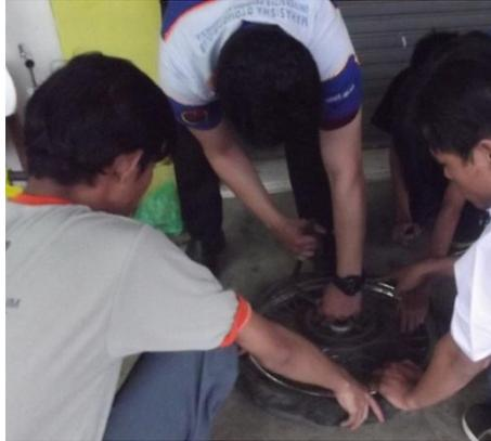
Gambar 14 Pendidik mendemonstrasikan pemasangan ban pada pelk
