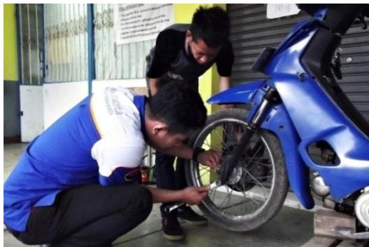
Gambar 2 Pendidik mendemonstrasikan proses melepaskan roda sepeda motor (Sumber: dokumen pribadi)
