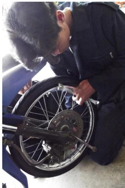
Gambar 19 Siswa mempraktekan cara pemasangan roda pada sepeda motor
