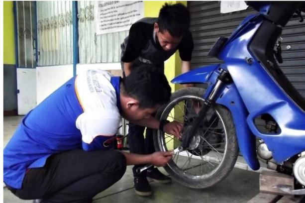
Gambar 18 Pendidik mendemonstrasikan cara pemasangan kembali roda pada sepeda motor
