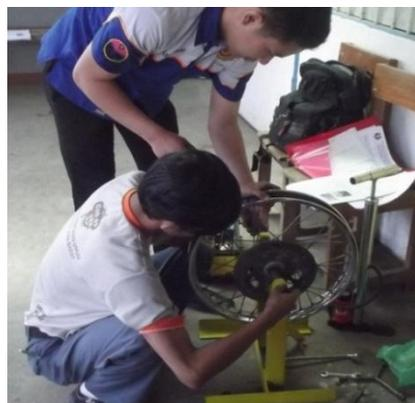
Gambar 7 Siswa mempraktekan cara memasang pelk pada alat penyetel pelk
