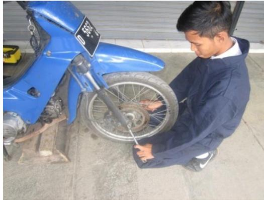
Gambar 3 Siswa mempraktekan proses melepaskan roda sepeda motor
