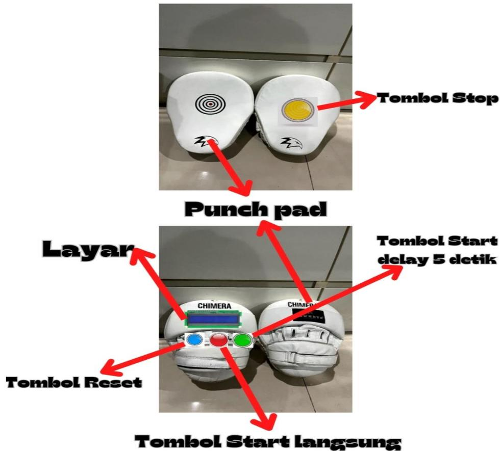
Gambar 3. 3 Bentuk-bentuk *Hardware* yang akan di Pasang
