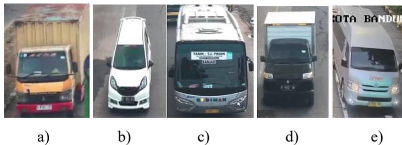
Gambar 3.3 Contoh Kelas Jenis Kendaraan: a) Truk, b) SUV-MPV, c) Bus, d) Pick Up, e) Mini Bus
