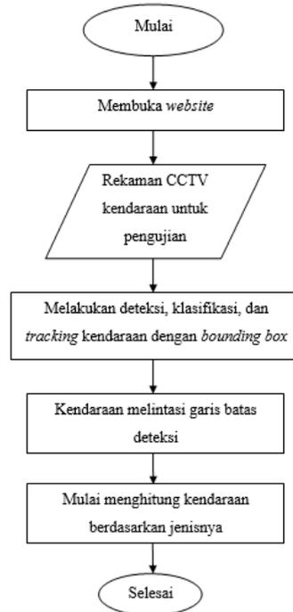
Gambar 3.5 Diagram Alir Proses Pengujian Sistem
