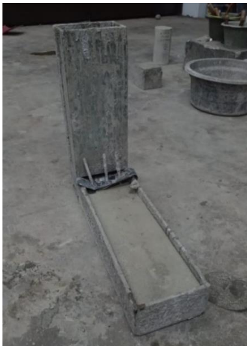
Gambar 3. 4. Alat Uji L-Box
