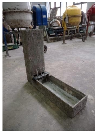
Gambar 3.4 Alat L-Box (Sumber : Penulis, 2024)
