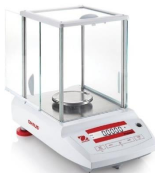
Gambar 3. 1 Neraca Analitik Ohaus Pioneer Sumber: (PT. Andalan Bangun Sejahtera, 2016)
