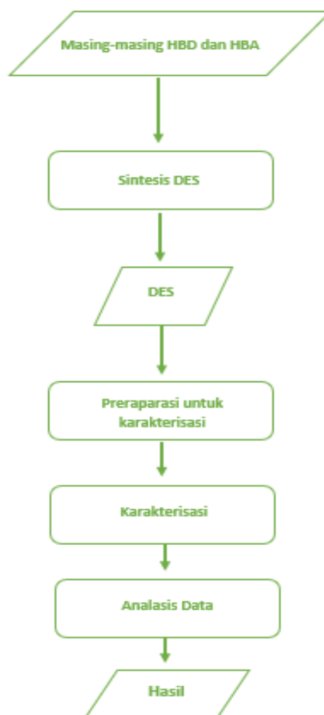
Gambar 3.1. Diagram alir sintesis EILs
