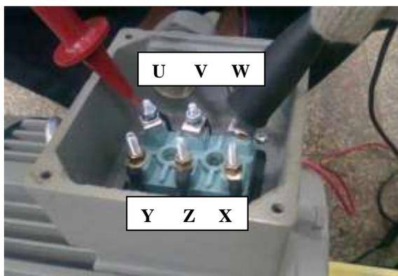
**Gambar 3.11** Pengukuran Tahanan Isolasi (Fasa Ke Fasa)
