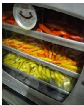
Gambar 3.7 Pengeringan Sampel menggunakan Oven Suhu 40oC
