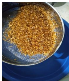
Gambar 3.9 Penyaringan Sampel menggunakan Saringan 100 Mesh
