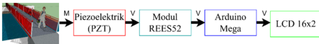
Gambar 3. 2 Diagram blok sistem pemantauan miniatur jembatan
