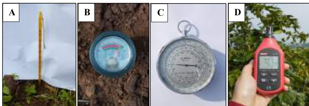
Gambar 3.5. Pengukuran Faktor Abiotik di Tempat Pengambilan Bahan: A. Soil tester; B. Termometer; C. Altimeter; D. Thermohygrometer
