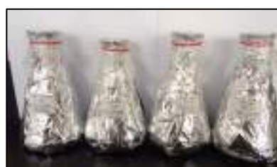
Gambar 3.14. Maserasi Serbuk Simplisia
